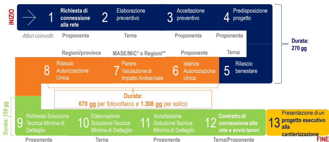
Figura 36. Rappresentazione dell' iter autorizzativo in Italia per un impianto FER. (*) MASE: Ministero dell'Ambiente e della Sicurezza Energetica. MiC: Ministero della Cultura. (**) A seconda della potenza dell'impianto, l'Autorizzazione Unica può essere statale o regionale. N.B.: Questi 13 step possono essere ricondotti alle 5 fasi della procedura di connessione di Terna: richiesta di connessione (da 1 a 4), predisposizione del progetto (5 e 6), iter autorizzativo (7 e 8), richiesta STMD (da 9 a 11), contratto di connessione (12 e 13). Fonte: elaborazione The European House – Ambrosetti su fonti varie, 2025.
