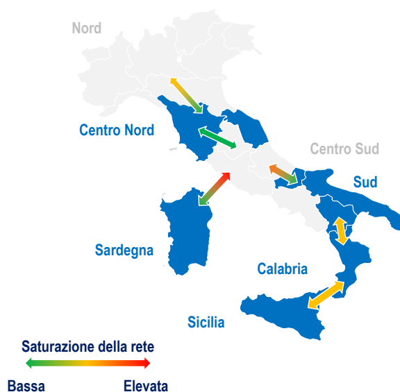
Figura 37. Saturazione della rete di trasmissione per zona di mercato (illustrativo), 2024. Fonte: elaborazione TEHA Group su dati GME e TERNA, 2025.
